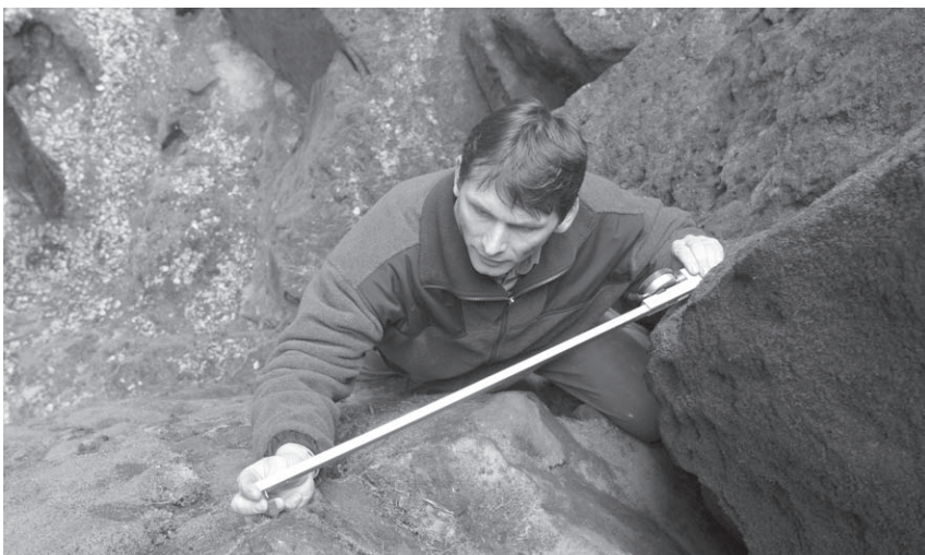
23 Kontrolní monitoring rizikových skalních objektů v NP České Švýcarsko (ruční měření) / Überwachung von risikobehafteten Felsenobjekten im Nationalpark Böhmisches Schweiz (manuelle Messung)
