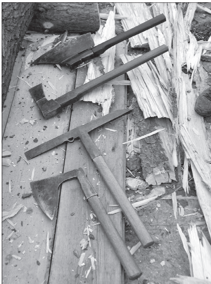
Nejčastěji užívané klasické tesařské sekery; od shora: širočina, hlavatka, křížovka; dole: replika středověké symetrické širočiny.
