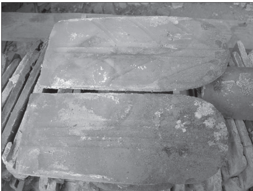
Ruční tašky bobrovky nalezené v zásypů stropu dokládají původní krytinu kaple.
