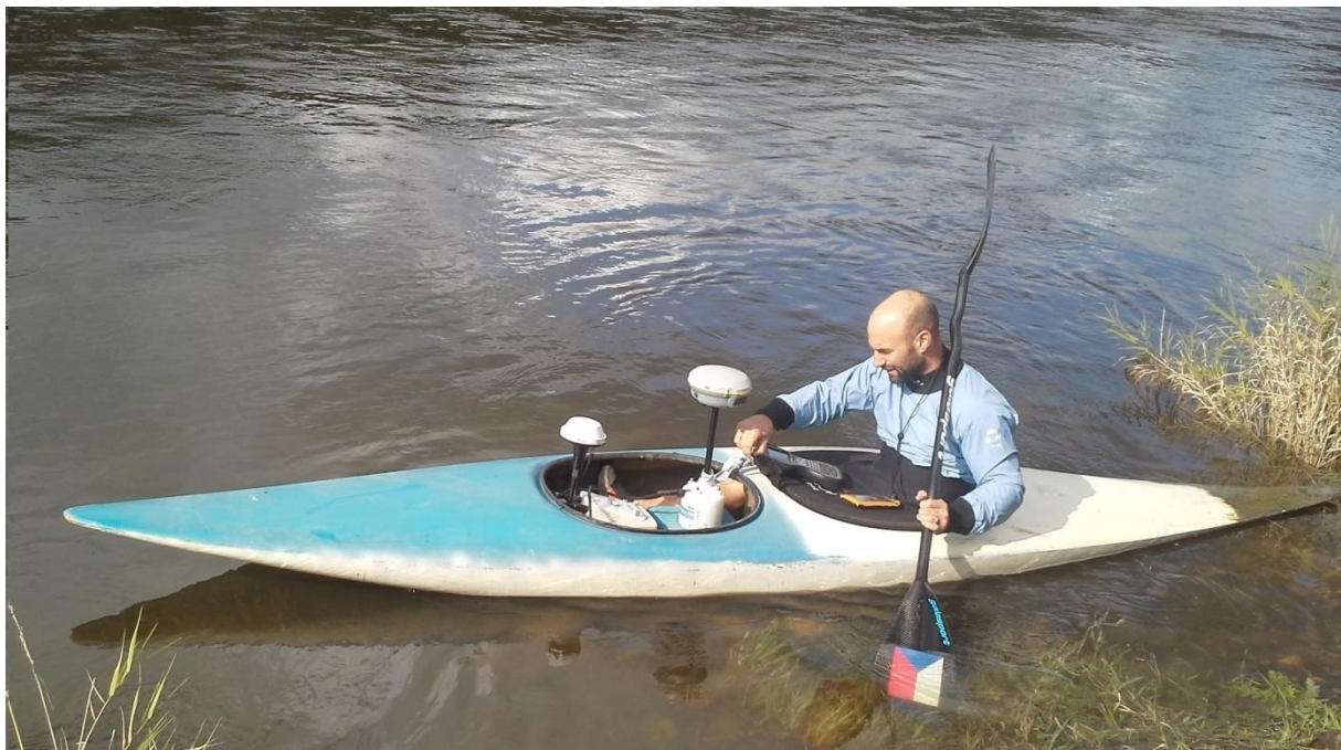
Obr. 1. Měřicí plavidlo osazené přístrojovým vybavením.
