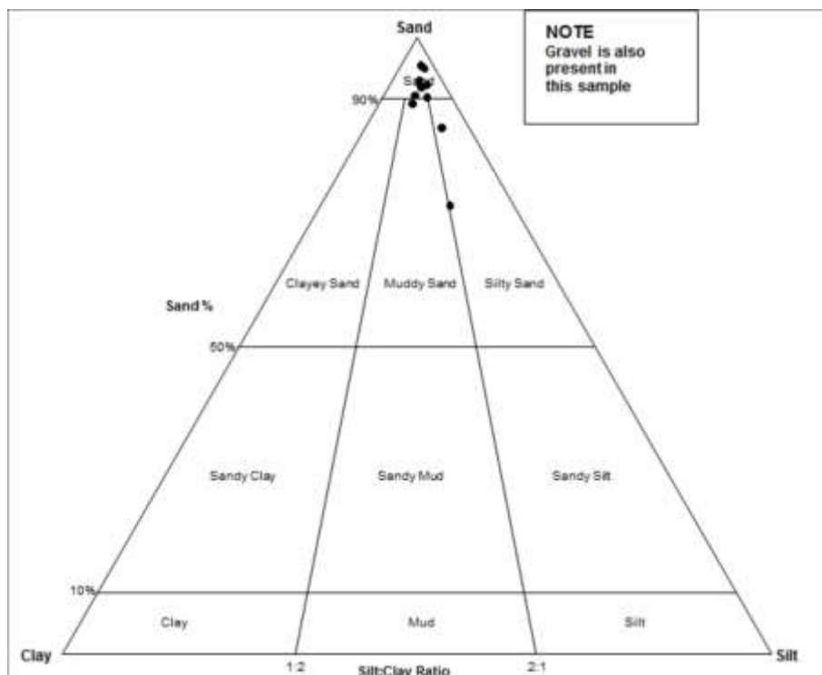
Příloha 9: Ternární diagram znázorňující zrnitostní složení odebraných vzorků na lavicích v Dolním Žlebu na základě relativního podílu písku-siltu-jílu dle Folk (1954).
