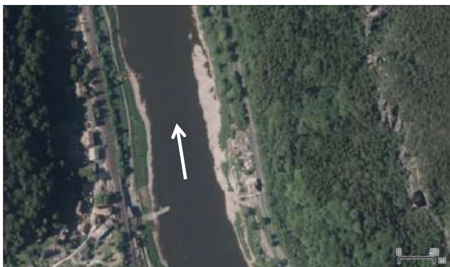
Obr. 3.5: Prohrábkami a vyhrnováním sedimentů z centrální části koryta řeky Labe disturbovaný korytový náplav v oblasti Děčína – městské části Dolní Žleb na leteckém snímku z roku 2015 (zdroj: Český úřad zeměměřický a katastrální).
