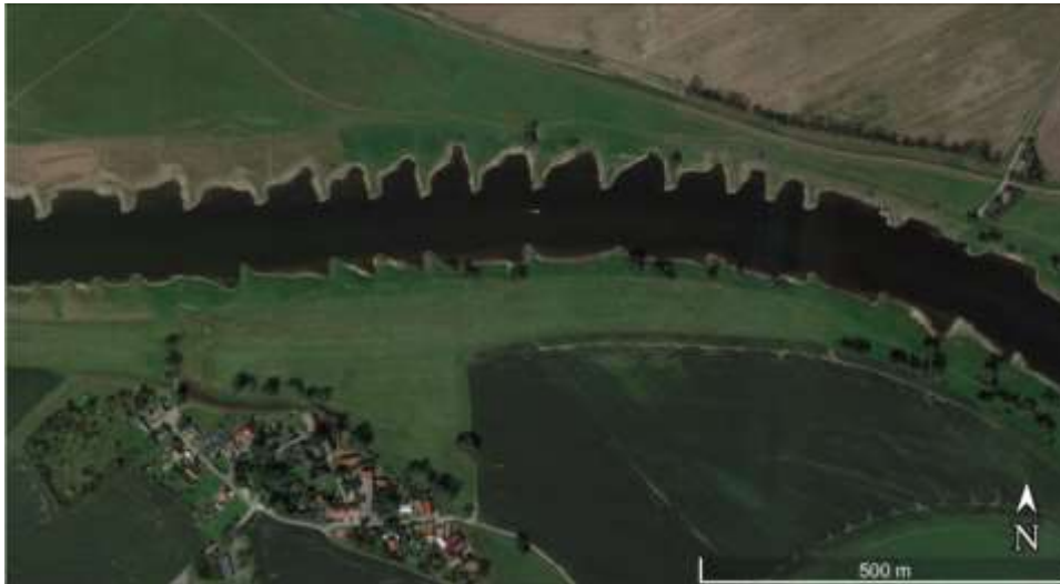
Obr. 3.3: Usměrňovací výhony na Labi na leteckém snímku z roku 2017 poblíž obce Lößnig (Lössnig) ve Spolkové republice Německo (zdroj: Google Earth).
