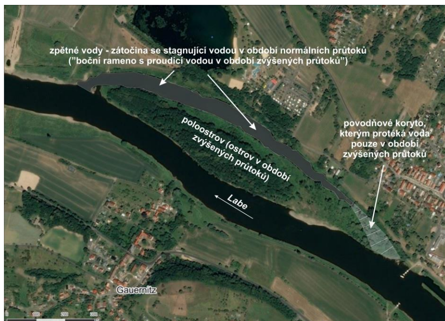
Obr. 3.11: Gauernitzer Elbinsel, vyvinutá zpětná voda (zátočina) s poloostrovem, která se mění v případě zvýšených průtoků na boční rameno řeky Labe s ostrovem (zdroj: Mapy.cz)
