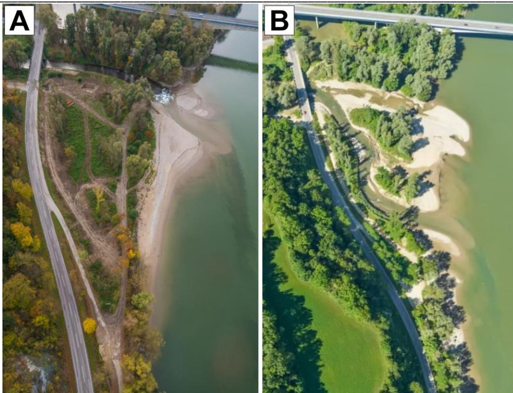
Obr. 3.5: Letecká fotografie ústí řeky Pielach do Dunaje před a po revitalizaci (zdroj: [2]).
