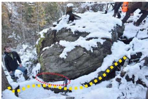
Obr. 4 Žlutá tečkovaná linie zvýrazňuje kořen stromu obepínající skalní blok, který může iniciovat pohyb vývratem nebo při jeho kácení. Červená elipsa zvýrazňuje místo indikující pohyb bloku v řádu prvních cm.
