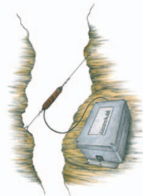
Automatický měřící systém – pomocí tohoto přístroje monitorujeme pohyb a otřesy skal.
