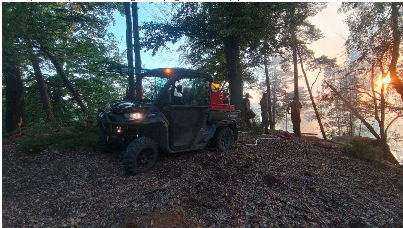
1/2ty 1/2kolka s hasebn 1/2 n 1/2stavbou, kterou spr 1/2va parku po 1/2 1/2dila po zku 1/2enosti s lo 1/2sk 1/2 1/2m po 3/4 1/2rem u H 1/2enska, pomohla p 1/2eklenout dobu, ne 1/2 1/2 hasi 1/2 1/2i polo 3/4 1/2ili n 1/2kolik stovek metr 1/2 dlouh 1/2 veden 1/2 pro hařjen 1/2 ze zem 1/2. Foto: Miroslav Rohl 1/2k
