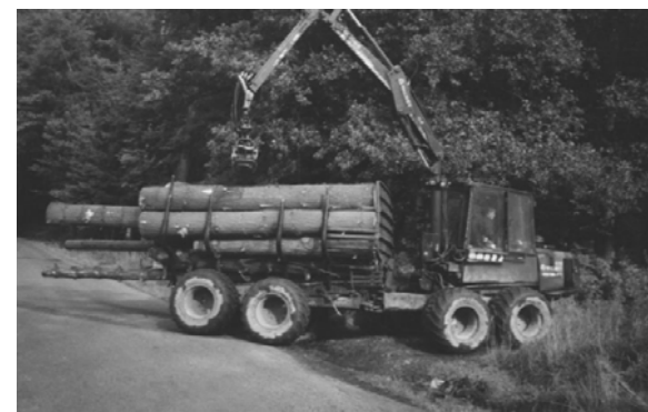
šetrné přibližování dřeva vyvážecí soupravou Valmet
