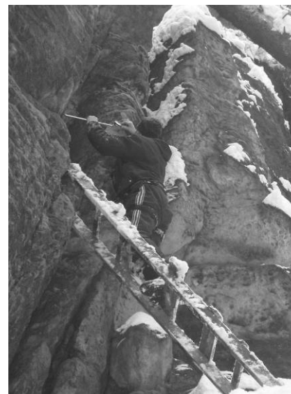
pravidelná 14-ti denní dilatometrická měření na lokalitě Soorgrund
