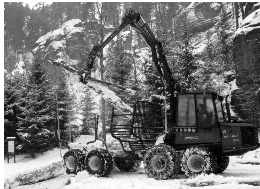
Šetrné přibližování dřeva vyvážecí soupravou VALMET
