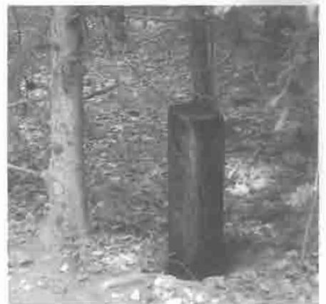
Nenápadný sloupek v lese. Sčítače jsou umístěny ve dřevěném sloupku a nepůsobí v krajině rušivě.
