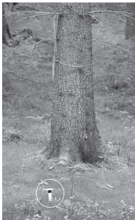
Umístění mikroklimatické měřicí stanice v terénu. Barevná páska na stromě umožňuje výzkumníkům snadné nalezení stanice. Foto: I. Marková
