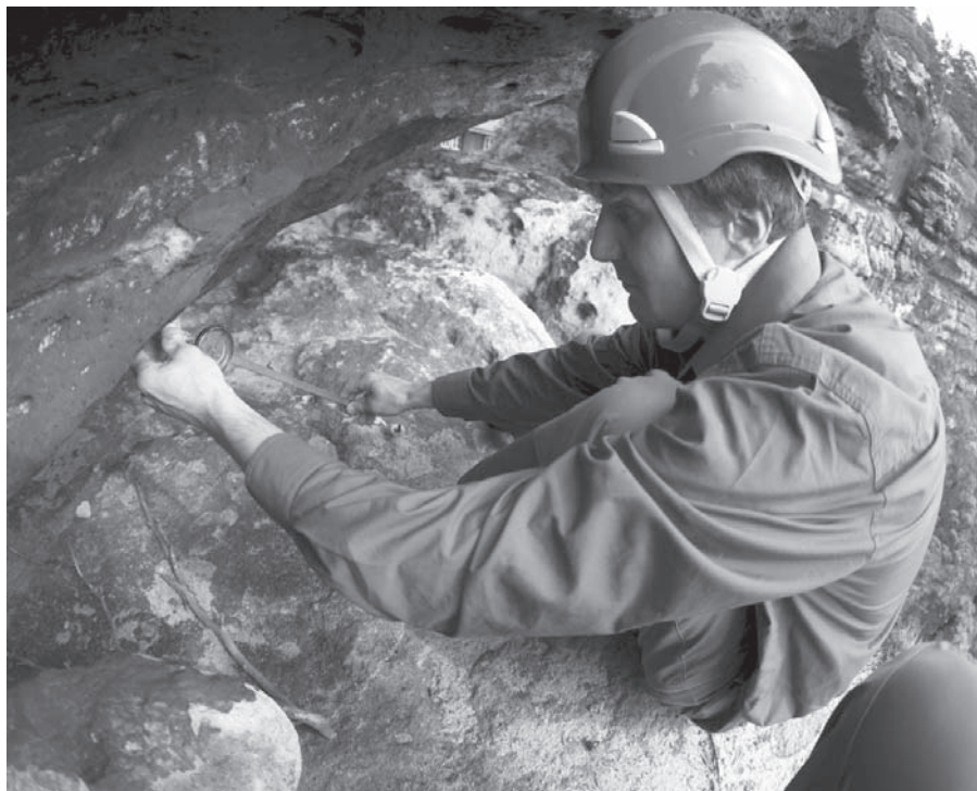
Skalník provádějící ruční dilatometrické měření. Foto: V. Sojka
