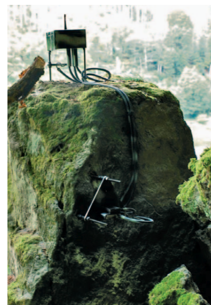
Tiltmetr osazený na nestabilním skalním masivu ve Schmilce.
