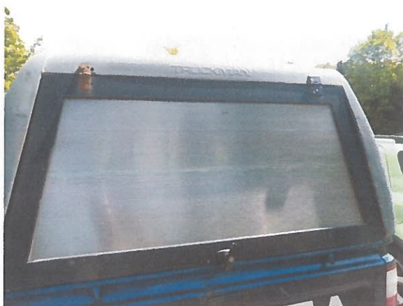
Obr. P8 – Náhrada dveří zavazadlového prostoru provizorním víkem z dutinkového polykarbonátu
