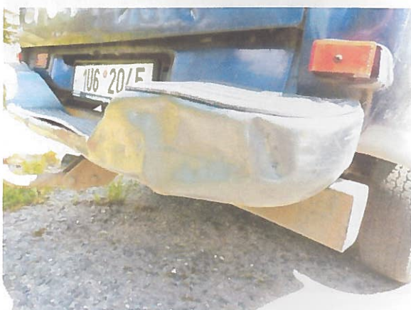
Obr. P6 – Deformace zadního nárazníku
