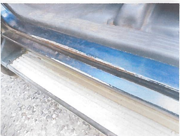
Obr. P11 – Koroze kabiny na jejím prahu
