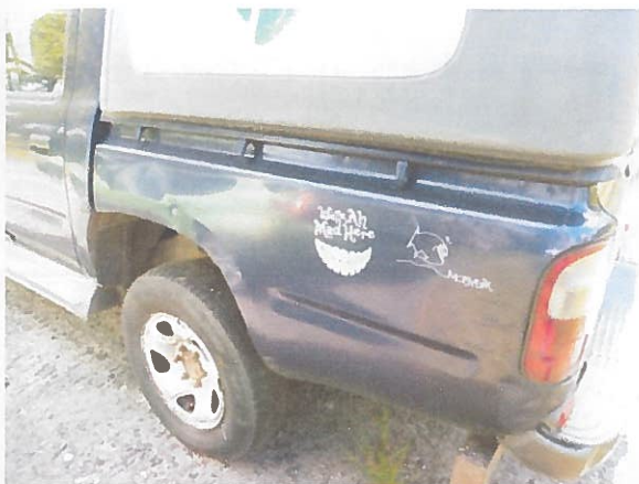
Obr. P7 – Deformace levé zadní bočnice
