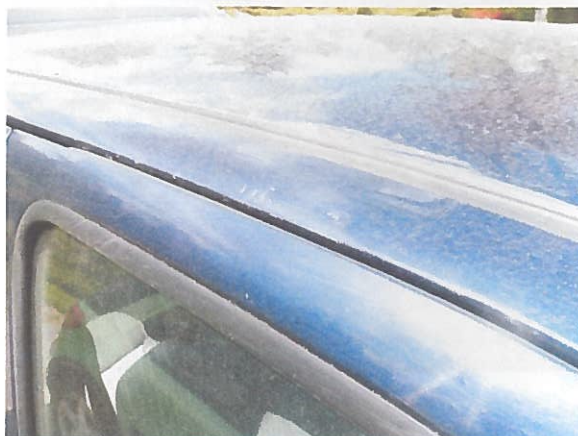
Obr. P4 – Pohled na deformaci střechy
