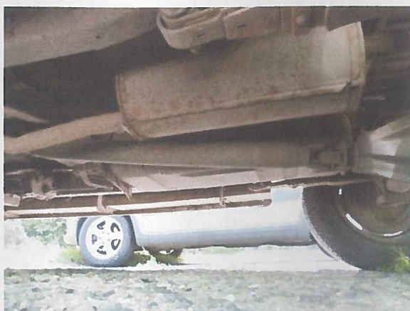
Obr. P18 – Koroze výfukového potrubí a podvozkových částí
