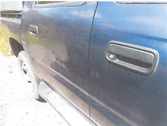
Obr. P3 – Pohled na deformace dveří na pravém boku kabiny
