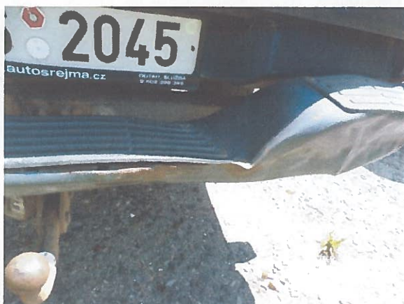
Obr. P5 – Deformace zadního nárazníku
