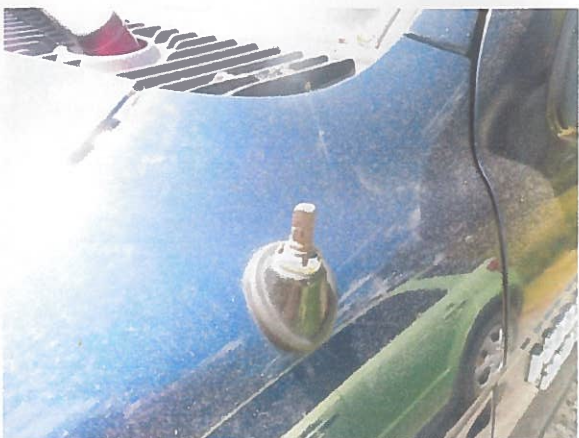
Obr. P9 – Poškozená anténa
