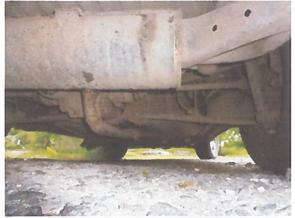
Obr. P8 – Koroze zadní nápravy, podlahové části a výfukového potrubí
