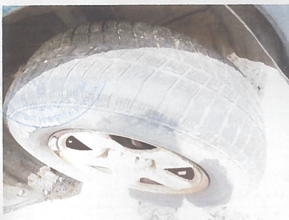
Obr. P17 – Detail dezénu pravé přední pneumatiky se sjetým vzorkem na vnější straně
