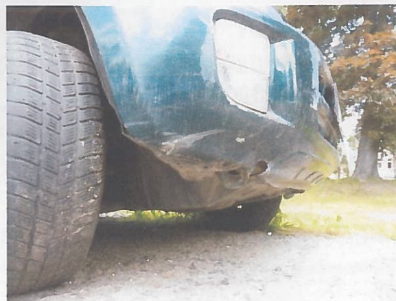
Obr. P18 – Detail poškozeného předního nárazníku
