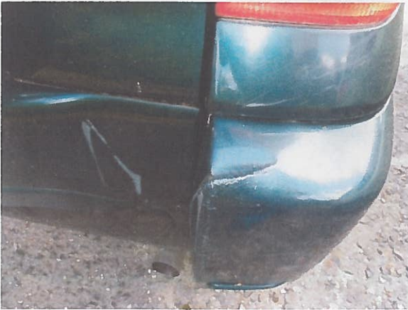
Obr. P9 – Poškození krytu zadního nárazníku na pravé straně
