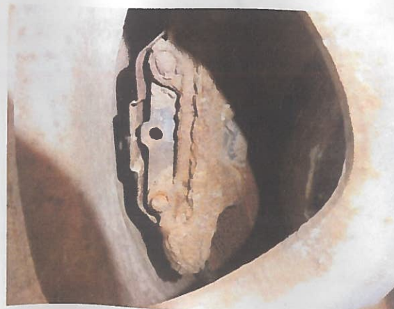
Obr. P6 – Totální koroze brzdíčů zadních brzd
