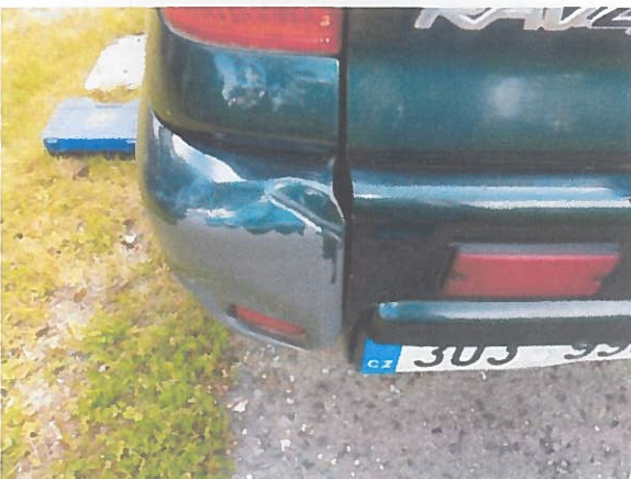
Obr. P9 – Poškození krytu zadního nárazníku na pravé straně
