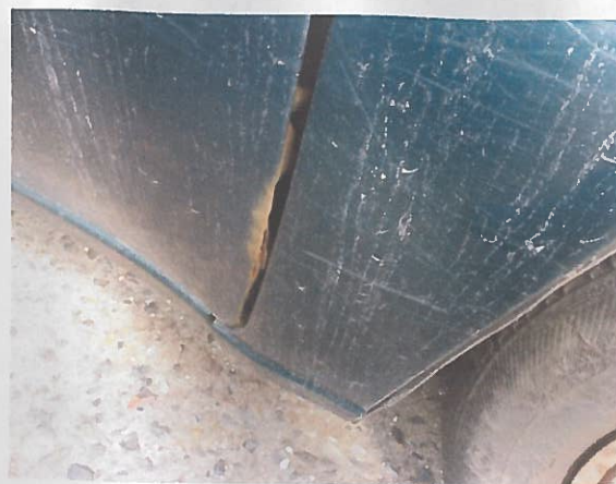
Obr. P4 – Detail koroze pravých předních dveří
