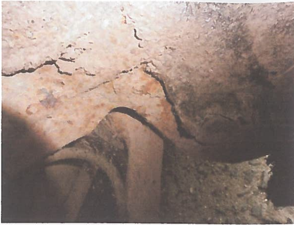
Obr. P7 – Koroze karosérie a zadní nápravy
