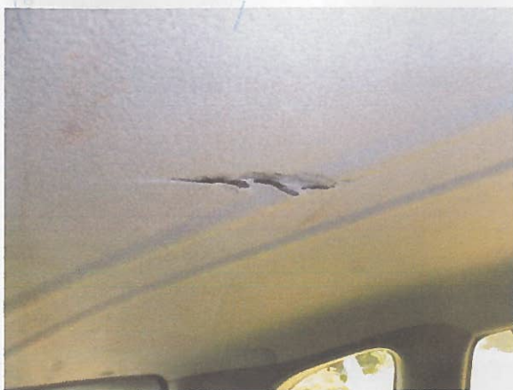
Obr. P15 – Znečištění a destrukce stropnice
