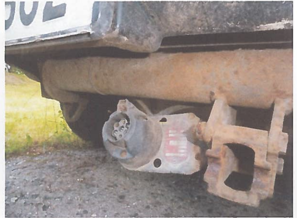
Obr. P8 – Koroze zadní nápravy, podlahové části a výfukového potrubí
