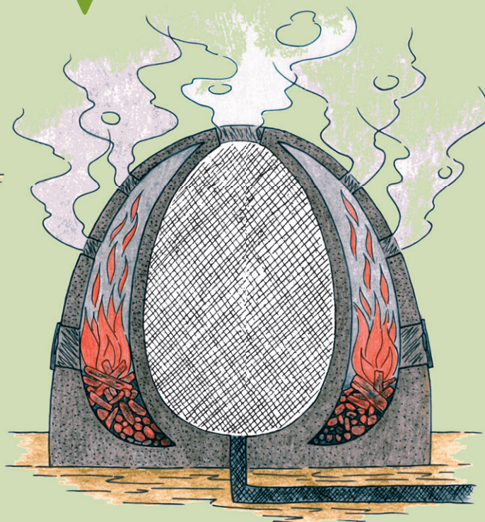
Průřez dehtářskou pecí
