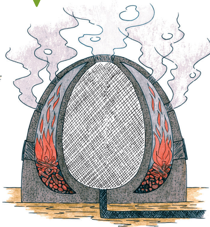
Průřez dehtářskou pecí
